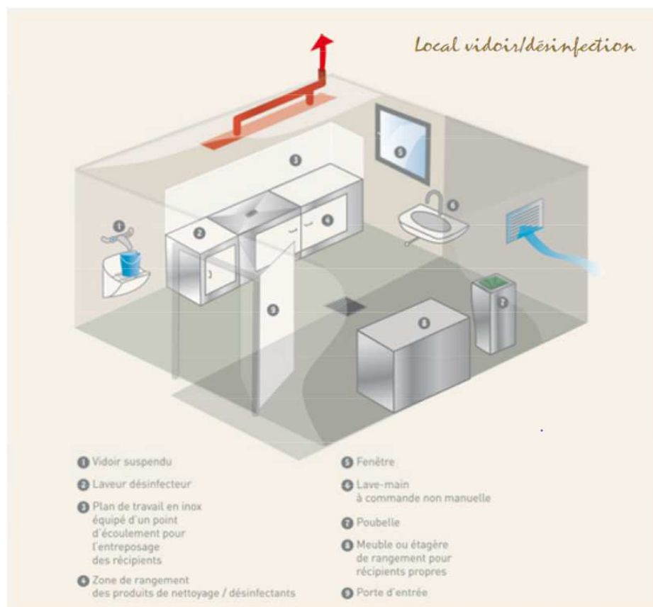
Exemple d'agencement d'un local vidoir. Source : INRS, Conception et rénovation des Ehpad. 2012
